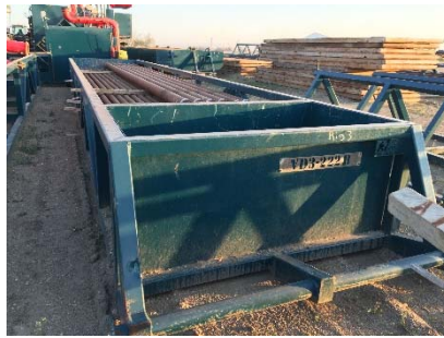
3.10.3 Pipe Tub VD3 - 222B
