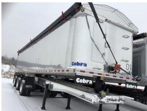
Remorque à benne basculante en aluminium, 40'
