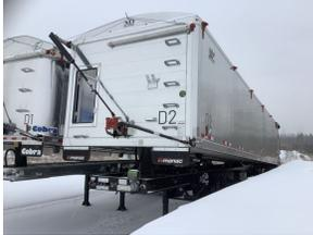
Remorque à benne basculante en aluminium, 40'
